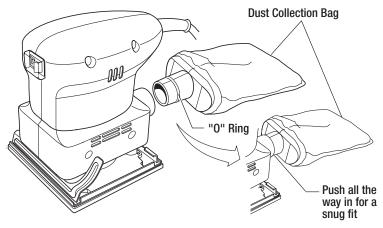
FIGURE 2. ATTACHING THE DUST COLLECTION BAG
